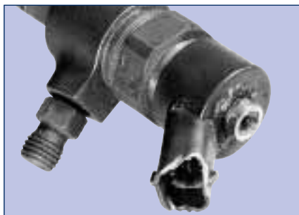
Injector: Beschädigung an elektrischen Anschlüssen
