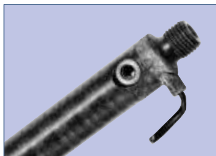
Beschädigung am Kabel bei DHK mit Bewegungsfühler
