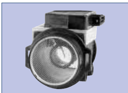
Hitzdraht-Luftmassenmesser: Beschädigung an Temperaturfühler, Zylindergehäuse (ohne Deckel) oder Steckeranschluß
