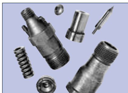
Düsenhalter ist unvollständig oder zerlegt
