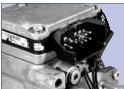
Beschädigung an den Anschlüssen
