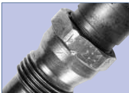
Beschädigung an Schlüsselstellen
